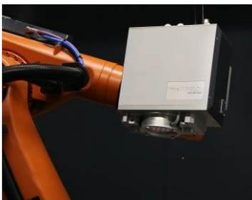
Remote-Schweißen mit Scan-Systemen, die an Industrieroboter montiert sind, ist ein weitverbreitetes Bearbeitungsverfahren in der Automobilfertigung, das auch für andere Branchen ein hohes Potenzial aufweist. Dabei übernimmt das Scan-System die Feinpositionierung des Laserstrahls und vermeidet so zeitraubende Neupositionierungen des Roboters. Damit wurden in den letzten Jahren die Auslastungsgrade der Strahlquelle und
